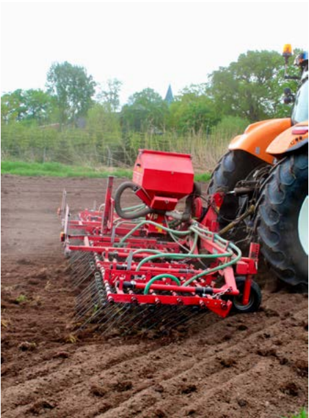
Der Grünlandstriegel mit pneumatischer Saatgutzuführung ist eine besonders geeignete Technik für die flache Aussaat von Wildkräutern und hochwertigen Saatgutmischungen. (Foto: M. Polaschegg)
