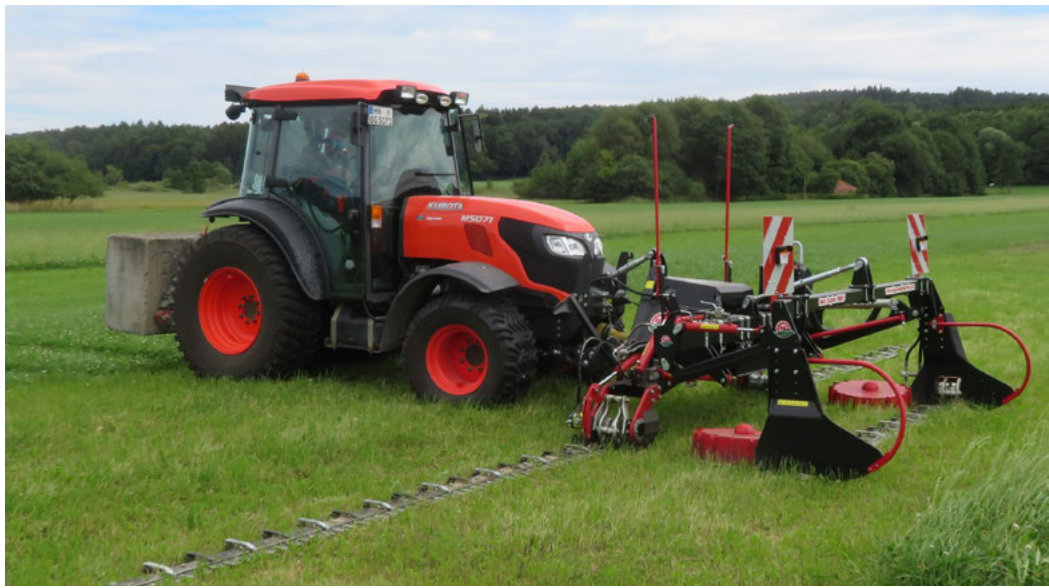
Abbildung 2.2: Beispiel eines Frontschmetterlings-Doppelmessermähwerks (Ottobeuren). Foto: Rainer Luick (2022)
