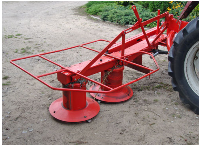
Abbildung 2.3: Kleines Trommelmähwerk (ohne die üblichen Schleuderschutzvorhänge): Die Messer befinden sich unten an den von oben angetriebenen, rotierenden Trommeln. Foto: Viesturs Kalvans/stock.adobe.com
