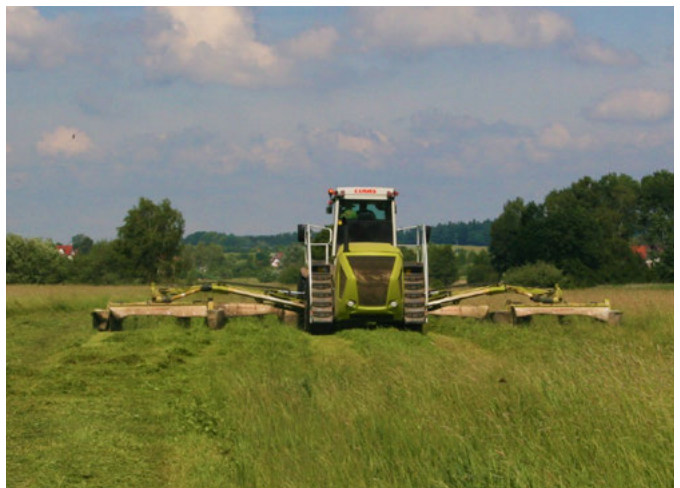
Abbildung 2.5: Ein Arbeitsgerät mit vier Scheibenmähwerken und insgesamt 14 m Arbeitsbreite. Geräte mit einer solch großen Arbeitsbreite werden vor allem in den Regionen mit besonders intensiver Grünlandnutzung in Nord- und Ostdeutschland sowie im westlichen Voralpengebiet eingesetzt. Die Flächenleistung liegt nach Angaben des Herstellers bei 100 ha pro Tag. Foto: Rainer Luick (2010)
