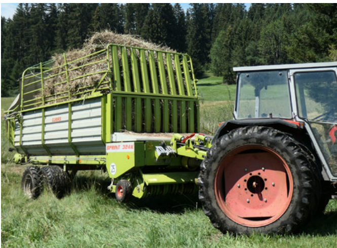
Abbildung 2.18: Insbesondere bei Ladewagen, die mit der Aufnahme des Mähguts ein beträchtliches Gewicht erlangen, ist die Zwillingsbereifung hilfreich für das Befahren feuchter Flächen. Foto: Leonie Schaefer (2022)
