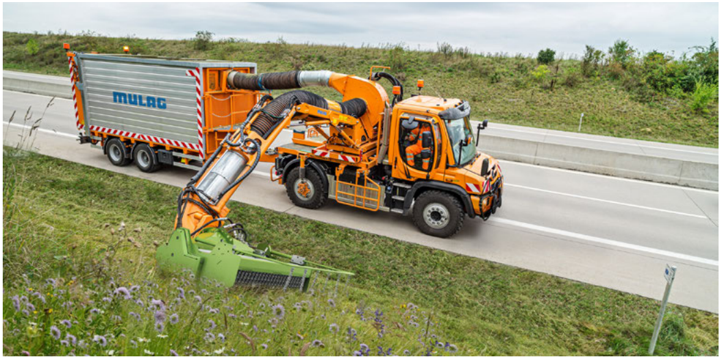
Abbildung 2.25: Einsatz eines MULAG-Eco-1200-plus-Mähkopfes an einem Unimog mit Sammelbehälter (Anhänger) auf der Autobahn. Foto: MULAG Fahrzeugwerk GmbH u. Co KG (o. J.)
