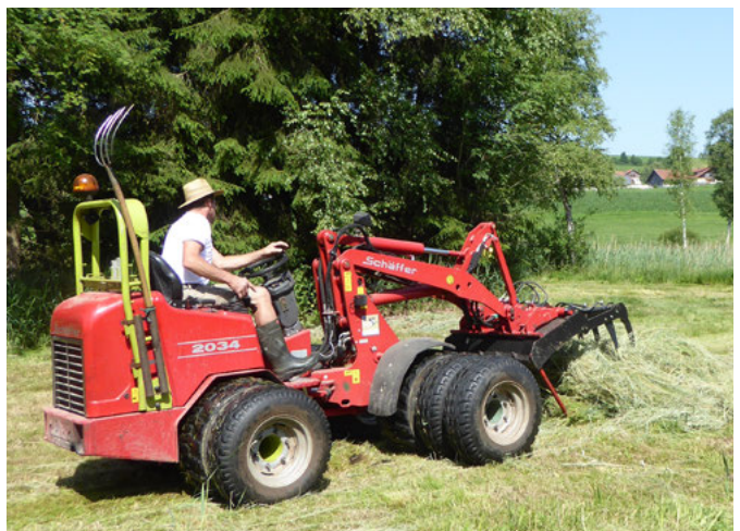
Abbildung 2.12: Für eine effiziente Bergung auf nassen Flächen wurde ein Hoftrac mit hydraulischer Heuzange und Drillingsbereifung auf beiden Achsen umgebaut. Damit kann bodenschonend geräumt werden. Durch die breite Bereifung ist die befahrene Fläche allerdings sehr groß. Foto: Leonie Schaefer (2020)
