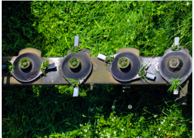
Abbildung 2.4: Ein Scheibenmähwerk (ohne die üblichen Schleuderschutzvorhänge): Die rotierenden Mähscheiben mit den Messern werden von einem Stirnradgetriebe (Satellitenantrieb) in einem flachen Getriebekasten (Mähholm) angetrieben. Foto Оксана Скиданова/stock.adobe.com
