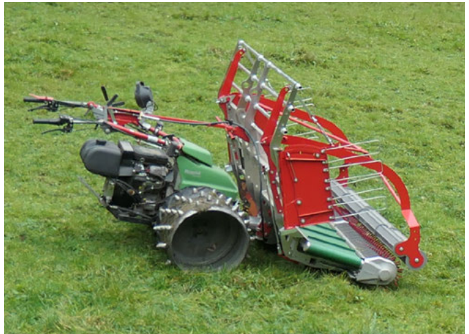
Abbildung 2.11: Mit Heuschiebern vom Typ Twister/Multi-Twister kann Mähgut im steilen und ebenen Gelände geschwadet (wenn die Seitenklappen geöffnet werden) oder in einem Arbeitsgang aufgenommen werden. Auf besonders nassen Standorten ist die Variante mit Tastrollen in Form von Doppelrollen von Vorteil, damit das aufgenommene Material das Gerät nicht in den Boden drückt. Foto: Leonie Schaefer (2022)
