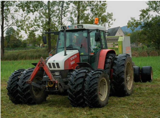
Abbildung 2.17: Spezialtechnik im Einsatz: Während die Mahd auch mit leichtem Gerät erfolgen kann, ist die Materialbergung anspruchsvoll und erfordert breite Bereifung, um die Flächen befahren zu können (Ohlstadt [BY]). Foto: Andreas Zehm (2007)
