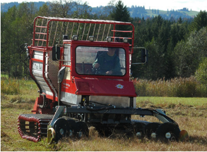
Abbildung 2.16: Auf nassen Böden können Mähraupen eingesetzt werden, die das Material in einem Arbeitsgang schneiden und abtransportieren. Die Bodenbeanspruchung ist beim Raupeneinsatz gering, Arthropoden haben aber kaum die Möglichkeit, aus dem gemähten Material zu entkommen. Alternativ muss das Material auf Planen herausgezogen werden, was viel Handarbeit erfordert (Huglfing, Deimenried [BY]). Foto: Andreas Zehm (2008)
