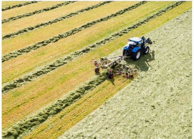
Abbildung 2.8: Der Schwader konzentriert mit gesteuerten rotierenden Zinken das Erntegut zur Aufnahme auf einer Linie. Foto: Countrypixel/stock.adobe.com
