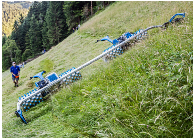
Abbildung 2.10: „Brielmaier Duo 6“ im Einsatz. Der flexible Mähbalken kann sich bedingt dem Relief anpassen. Breite Stachelwalzen sorgen für den nötigen Halt, selbst in extremen Hanglagen. Dadurch vergrößert sich allerdings auch die überrollte Fläche; das System kann ferngesteuert werden (Allgäu). Foto: Fa. Brielmaier (2015)
