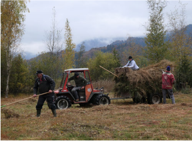
Abbildung 2.13: Ein zwillingsbereifter Hanggeräteträger bzw. Zweiachsmäher mit kleinem Anhänger kann auch auf Moorstandorten eingesetzt werden. Händische Zuarbeit ist dennoch in hohem Maße erforderlich. Foto: Leonie Schaefer (2020)
