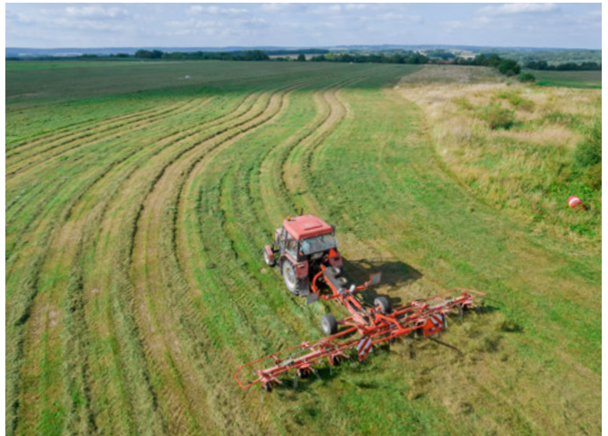
Abbildung 2.7: Zetten und Wenden sind bei der Heuwerbung Arbeitsschritte zur Trocknung des Aufwuchses. Die Maschine arbeitet mit rotierenden Zinken. Foto: Yaroslav/stock.adobe.com
