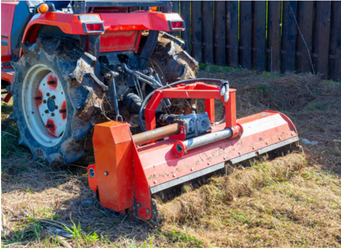
Abbildung 2.19: Schlegelmulcher im Heckanbau. Ziel des Mulchens ist es, in einem Arbeitsgang den Aufwuchs zu kürzen, zu zerkleinern und breitflächig abzulegen. Der Aufwuchs bleibt ungenutzt. Kettenvorhänge, Pendelklappen oder ähnliche Schutzvorrichtungen sollen, wie auch bei rotierenden Mähwerken, das Herausschleudern von Fremdkörpern verhindern. Foto: Sergey/stock.adobe.com
