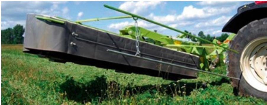
Abb. 10: Beispiel für einen einfachen Anbau an ein Mähwerk, der dadurch, dass er die Vegetation direkt vor der Mahd abstreift, manche Mahdverluste vermeiden kann, da sich verschiedene Arten (wie Käfer) herabfallen lassen oder (wie beispielsweise Schwebfliegen) davonfliegen (aus NABU 2014). (Foto: Rainer Oppermann i. A. NABU Gärtingen)
