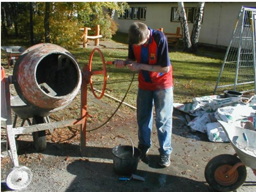
Motorbetriebene Geräte wie z. B. Betonmischer sollten nur von älteren Schülerinnen und Schülern nach sorgfältiger Unterweisung durch die Lehrkraft bedient werden.
