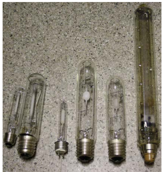
Abb. 2.3: Unterschiedlicher Leuchtmitteltypen, links: Halogenlampe, Kompaktleuchtstofflampe, LED, rechts: verschiedene Gasentladungslampen (z. B. Natriumdampf lampen, rechts Natriumniederdruckdampf lampen)
